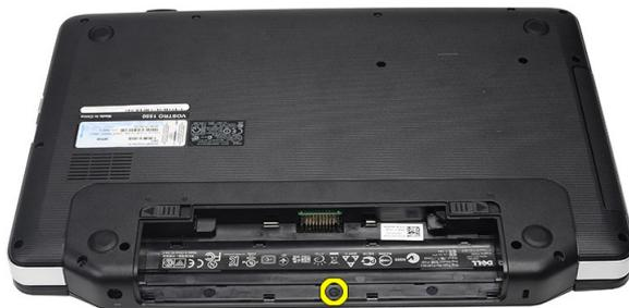
4. Drehen Sie den Computer um und entfernen Sie die Scharnierabdeckung.
