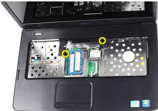
7. Hebeln Sie die Handballenstütze mit einem Stift aus Kunststoff nach oben und entriegeln Sie alle Schnappverschlüsse an der Unterseite sowie an der linken und rechten Seite der Handballenstütze. Sobald alle Schnappverschlüsse gelöst sind, heben Sie die Handballenstütze aus dem Computer und entfernen Sie sie.
