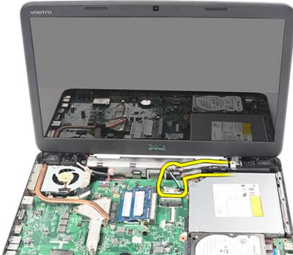
8. Entfernen Sie die Schrauben, mit denen die linken und rechten Scharniere befestigt sind.
