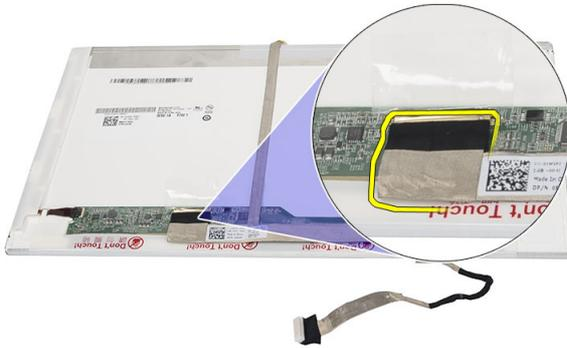
12. Lösen Sie das ganze Bildschirmkabel vom Klebeband, mit dem es am Bildschirm befestigt ist.
