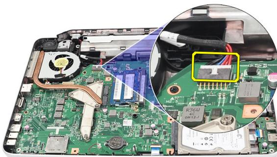
8. Entfernen Sie die Schraube, mit denen der DC-In-Anschluss und das Abschlussblech befestigt sind.
