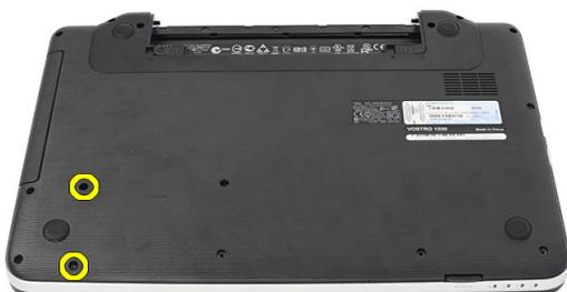
6. Entfernen Sie die Schrauben, mit denen die Festplattenlaufwerkhalterung befestigt ist, und entfernen Sie sie vom Festplattenlaufwerk.
