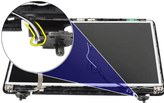
11. Lösen Sie das LVDS-Kabel aus dem linken Scharnier.
