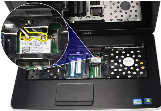
6. Hebeln Sie die Verriegelung nach oben, um die WLAN-Karte aus ihrem Fach zu lösen.
