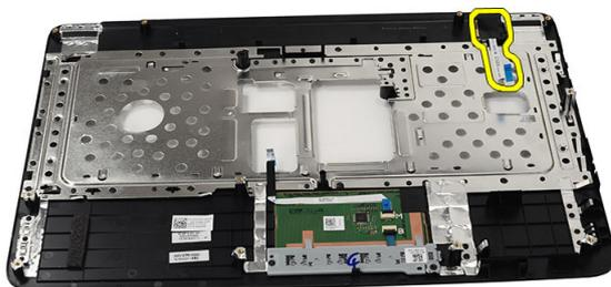
6. Drehen Sie die Handballenstütze um und entfernen Sie die Schraube, mit der die Betriebsschalterplatine an der Handballenstütze befestigt ist.
