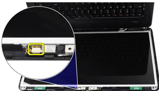
5. Hebeln Sie die Verriegelung auf, heben Sie die Kamera nach oben und entfernen Sie sie.
