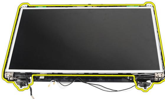
13. Entfernen Sie die Schrauben an den linken und rechten Bildschirmhalterungen und entfernen Sie den Bildschirm.
