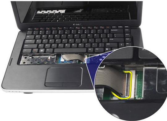
6. Entfernen Sie die Tastatur aus dem Computer.
