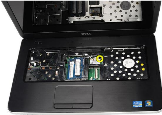
7. Entfernen Sie die WLAN-Karte aus dem Computer.
