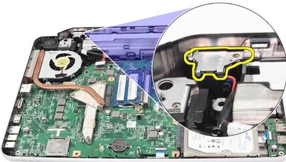
10. Heben Sie den DC-In-Anschluss aus dem Computer heraus und entfernen Sie ihn.
