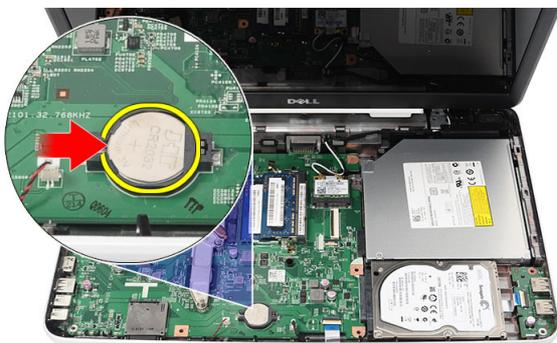
6. Entfernen Sie die Knopfzellenbatterie aus dem Computer.
