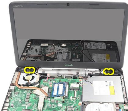
9. Heben Sie die Bildschirmbaugruppe aus dem Computer heraus und entfernen Sie sie.
