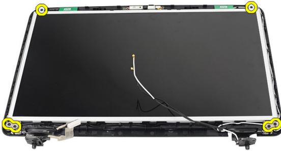
10. Lösen Sie die Wireless-Antennen aus dem rechten Scharnier.
