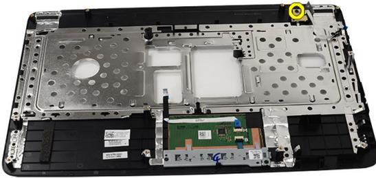
7. Heben Sie die Betriebsschalterplatte nach oben entfernen Sie das Kabel der Betriebsschalterplatte durch die Öffnung.
