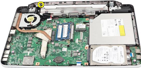
9. Heben Sie das Abdeckblech des DC-In-Anschlusses an.
